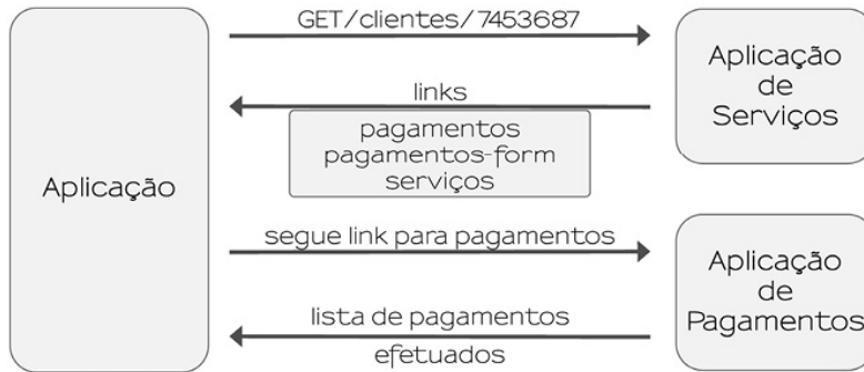
Figura 7.7: Devido ao acoplamento semântico com o link, e não com a URI, o cliente acessa o serviço de controle de pagamentos que o servidor utilizar.
